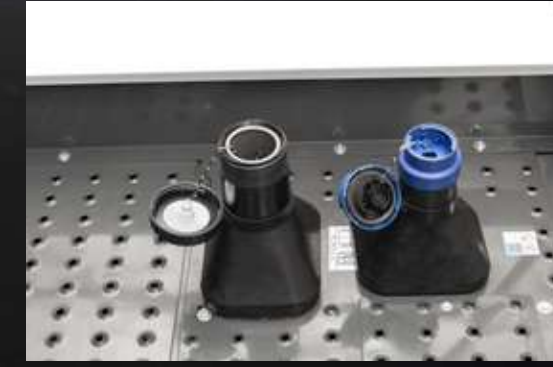
Kolay yakıt ikmali - kolay bir erişim için her iki depo yan yana yerleştirilmiştir
