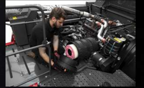
Hava filtresinin kontrolü ve temizliği
