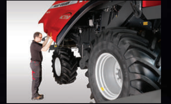
Hızlı bir servis erişimi sağlayan, aydınlatmalı tek parça yan kapaklar
