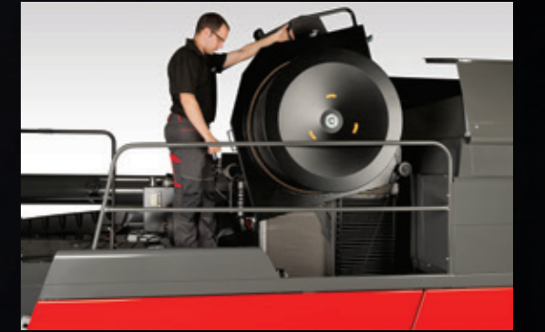
Radyatör temizliği için güvenli ve kolay erişim
